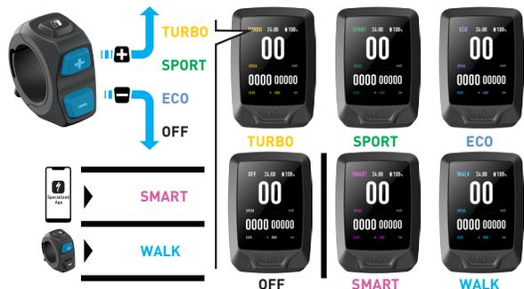
Le moteur propose 6 modes d'assistance différents : **TURBO**, **SPORT**, **ECO**, **OFF**, **SMART CONTROL** et **MICRO TUNE**.
